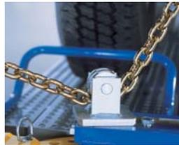
*La tracción hacia abajo resulta fácil con el sistema accesorio D91.*
