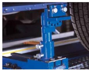
El sistema de soportes laterales bloquea las piezas en su sitio durante la tracción, o las mantiene fijas en operaciones de soldadura.
