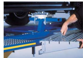
Las secciones de rampa desmontables se desenganchan fácilmente para proporcionar un mejor acceso al vehículo.
