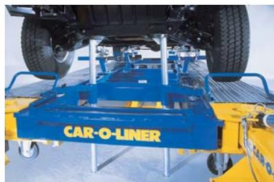
Avec une ou plusieurs de nos équerres de redressage de 10 tonnes, toutes les tractions peuvent être effectuées autour du banc.
