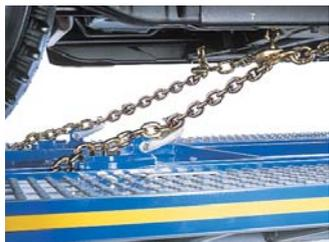
Para reparaciones de poca importancia, se puede anclar rápidamente el vehículo usando los soportes de cadena B631.
