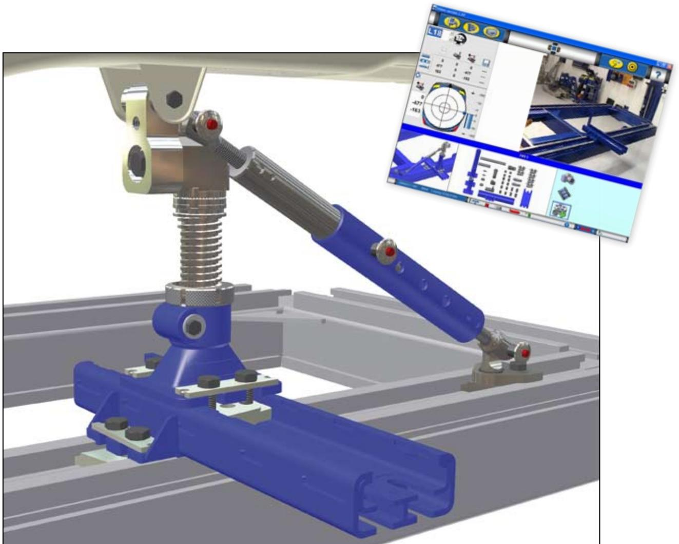
Sistema de prolongación, complementario del EVO 1, concebido para anclar, sujetar y prestar apoyo lateral durante la reparación: dos torres adicionales y chapas de rodadura, herramientas especiales para el soporte del eje trasero, prolongaciones de barras de par y soportes ajustables.
