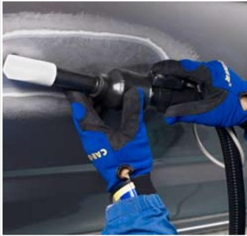
Contracción de paneles de acero y aluminio durante la reparación
