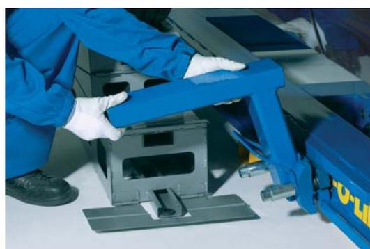
El brazo de montaje opcional (B310) se monta y desmonta a presión, para mayor rapidez de carga y descarga.
