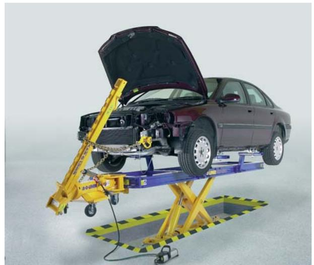
*El banco Mark 6 montado en un elevador de columna ofrece facilidad de colocación del vehículo, altura de trabajo variable y acceso fácil a los bajos del vehículo.*
