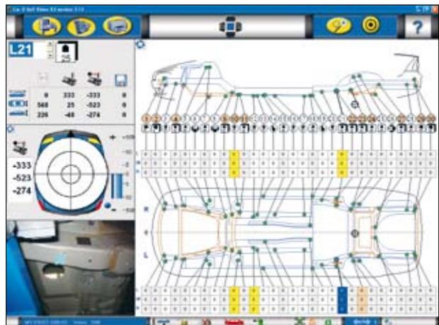
Sólo pulse el botón-diana para medir automáticamente. La función ASP presenta fotografías de los puntos de medida de forma automática a medida que el brazo de medida se desplaza de un punto a otro.
