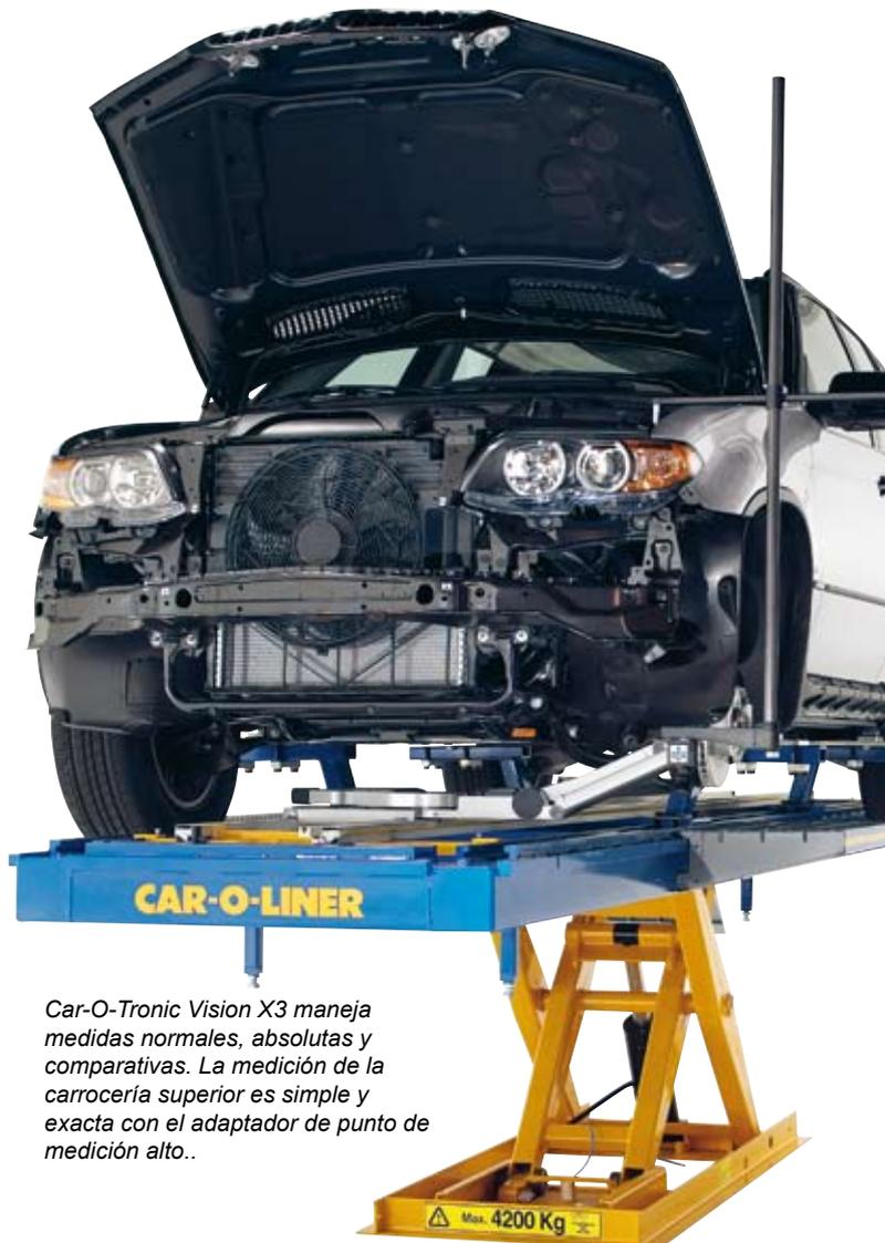
*Car-O-Tronic Vision X3 maneja medidas normales, absolutas y comparativas. La medición de la carrocería superior es simple y exacta con el adaptador de punto de medición alto..*
